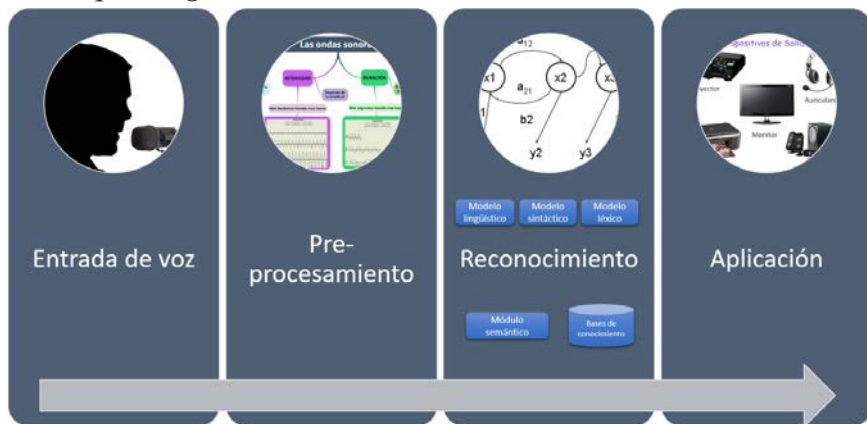
Figura 1 Esquema general de un sistema de reconocimiento de voz
